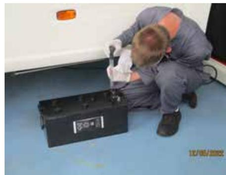
*Contrôle de la consommation de courant, de la tension de chute au démarrage et des batteries au densimètre. A la fin de chaque épreuve, les membres du Jury évaluent la prestation du candidat. Les résultats sont transmis directement aux MOF pour vérification et saisie de la note.*
